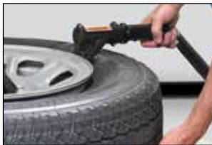
Tlakové dělo nasměřuje nápor vzduchu pro usazení patek na disk
