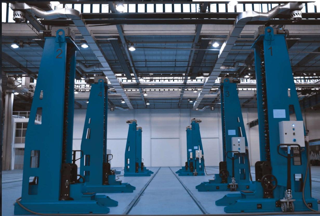
Sady patkových zvedáků o nosnosti 7,5 až 25 tun a rozsahu zdvihu 350–3200 mm. Každá sada je tvořena nejméně čtyřmi zvedáky. Počty zvedáků lze navyšovat (vždy o jeden pár) dle požadavků zákazníka. Pro snazší manipulaci při ustavení ke zvedacím bodům vozidla mohou být zvedáky vybaveny podvozkem s hydraulickým přízdvihem.
