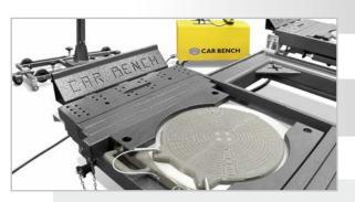
WHEEL ALIGNMENT TURNTABLES EMBEDDED IN THE SIDE RUNNERS IN N.4 LOCATIONS
