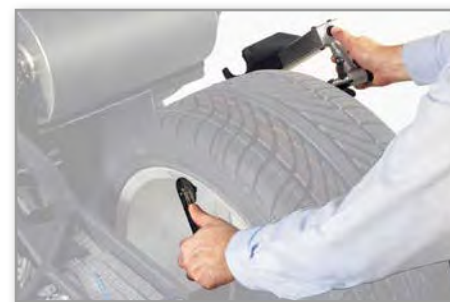
Road Force Touch® HU RFT00/10/20/30E Ramena pro měření rozměrů a házivosti ráfků
