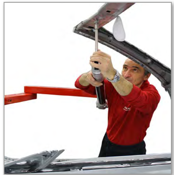
Elektronické měření umožňuje měřit body na střeše vozidla...
