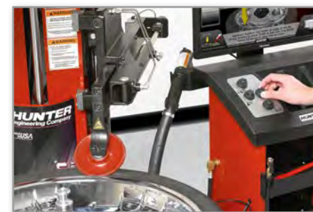
Nastavit průměr a polohu ventilků/snímače tlaku
