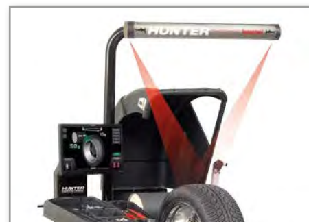
HammerHead® HU 20-2892-1 (příslušenství) Laser pro přesné umístění naklepávacích závaží
