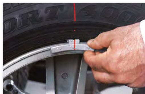
HammerHead® HU 20-2892-1 Laser pro přesné umístění nalepovacích závaží
