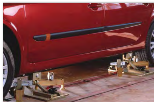
Sada rychlokotvení pro vozidlo na podlaze.
