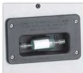
Modul analyzátoru hlídá minimální čistotu chladiva 95%
