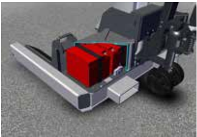
Alternativní napájení AGM bateriemi
