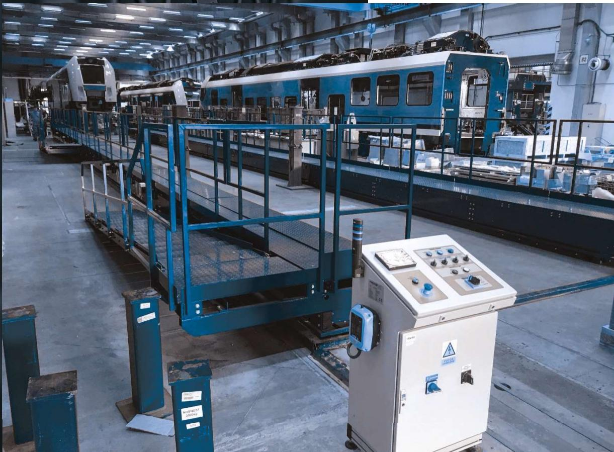
Montážní lávky v nůžkovém provedení s rozsahem zdvihu 300–4500 mm. Pevné montážní lávky s odkládací plošinou a výtahem. Pochozí šířka lávek je obvykle 800 mm, při využití elektricky ovládaných výsuvů až 1150 mm. Dle požadavků zákazníka lze lávky doplnit o osvětlení pracovního prostoru, přechodové moduly apod.
