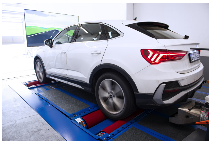
7 Test systémů vozidla v autoservisu pomocí zařízení MAST.
