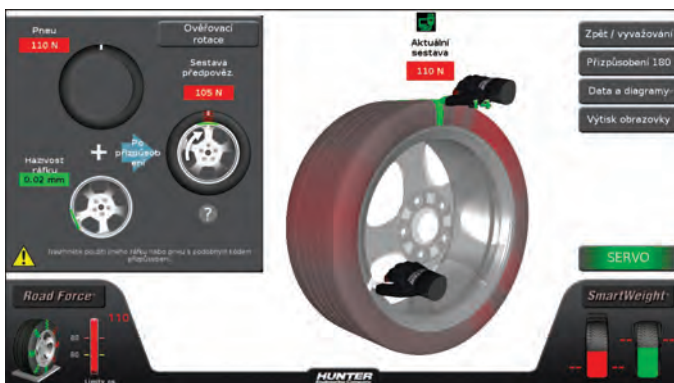
7 Typické poškození ve více bodech po opakované demontáži (tři samostatné zbarvené oblasti). Intenzita červeného zbarvení pneumatiky signalizuje tuhost bočnice.
