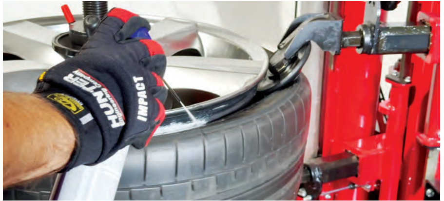
8 Dynamické odrážení: kladka tlačí přímo na patní lano. Mazací sprej (např. RFT) je při demontáži extrémně tuhých pneumatik skvělým pomocníkem.
