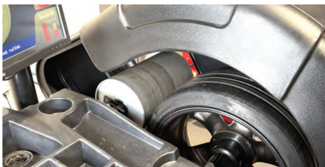
➊ Přítlačný válec vyvažovačky Hunter Road Force Elite při měření.
