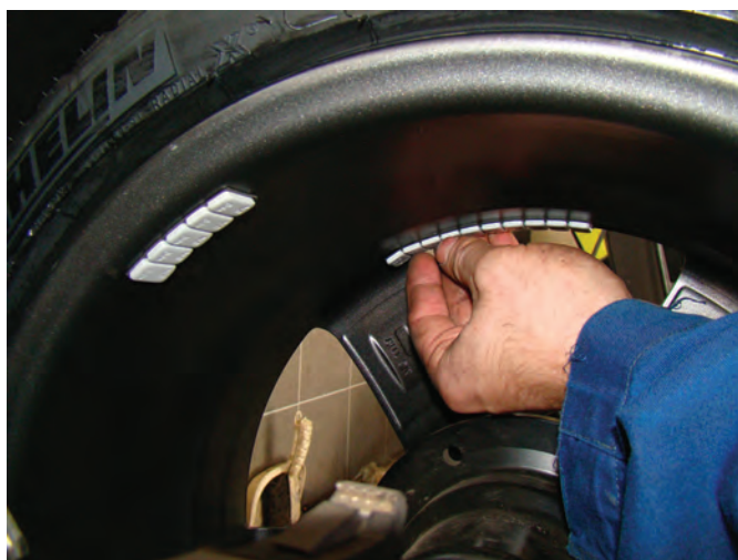
❶ Ideálně vyvážené kolo si vystačí pouze se dvěma závažími – vnitřním a vnějším.
