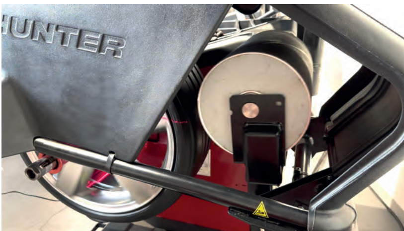
7 Pro správné zjištění stavu problematického kola je nutné provést zátěžovou zkoušku válcem na vyvažovače.
