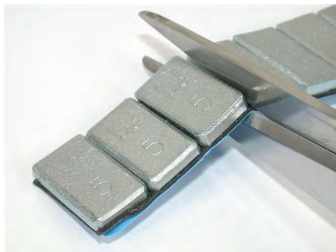
❷ Pokud dolepíte malou hodnotu závaží ke stávajícím, kolo bude rovněž správně vyvážené a přitom ušetříte čas.
