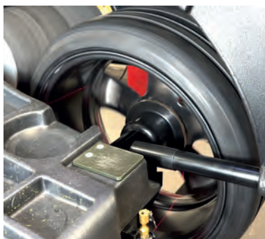
5 Laserové měřicí systémy, které některé vyvažovačky nabízejí, dovedou velmi přesně proměřit profil a tvar disku.
