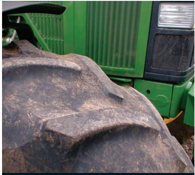
5 Nesprávně seřízenou geometrii lze poznat velmi rychle podle nadměrného opotřebením střední části pneumatiky.
