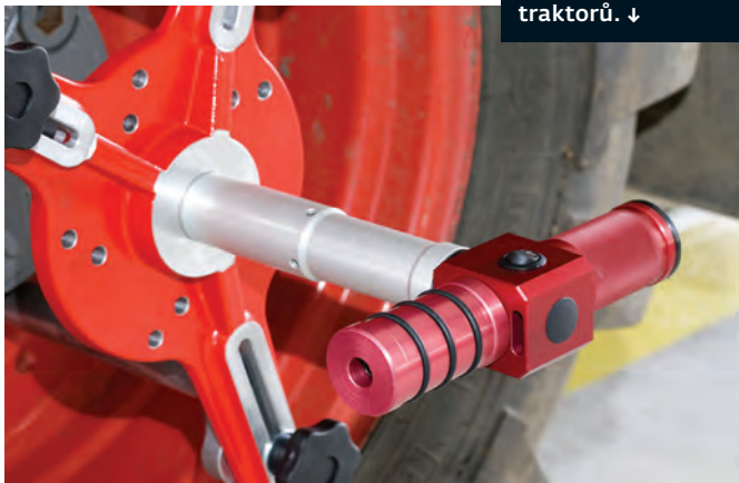
3 Speciální kolové upínáky pro měření geometrie traktorů. ↓
