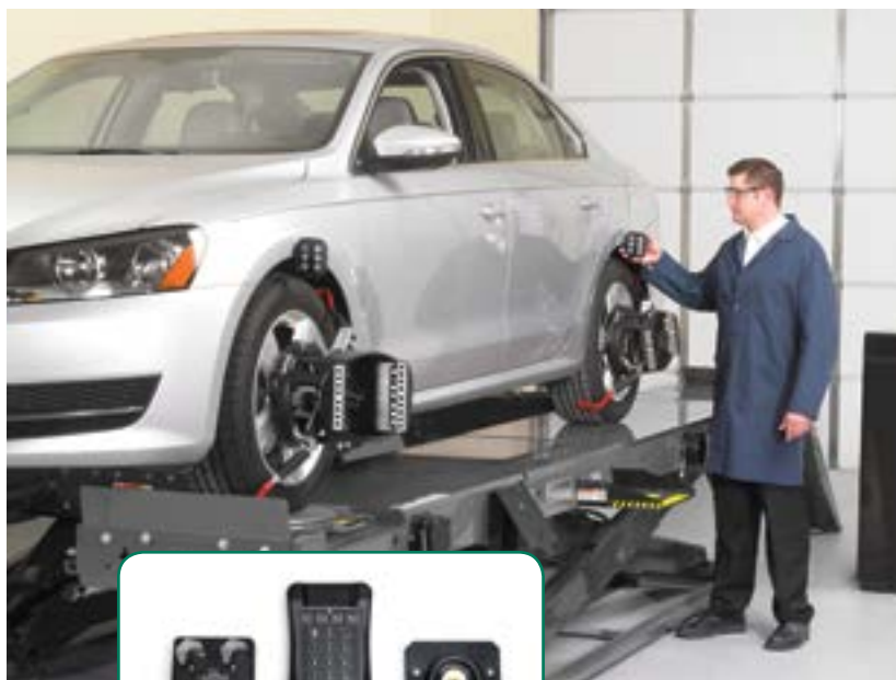
➊ Přesné měření světlé výšky vozidla se bez inklinoměru neobejde.
