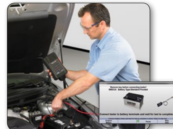
Technologie testování baterií Midtronics integrovaná do systému Hunter QuickCheck měří, zaznamenává a vyhodnocuje výsledky testu stavu baterií
