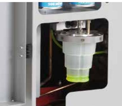
Patentovaná nádoba na použitý olej: zajišťuje, aby bylo veškeré obnovené chladivo vráceno do nádrže na chladivo
