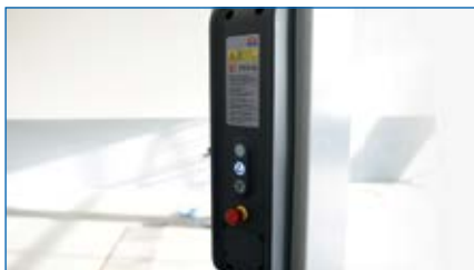
Druhý ovládací panel na protilehlém sloupu znamená méně chvil ze kolem zvedáku.
