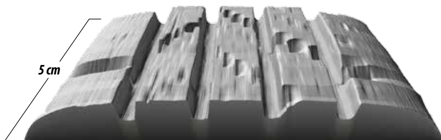
Výsledky měření zákaznickovy pneumatiky zobrazené jako 3D obraz.
