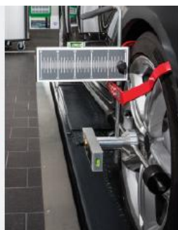
CSC Tool umístěte souběžně s vozidlem, dle návodu
