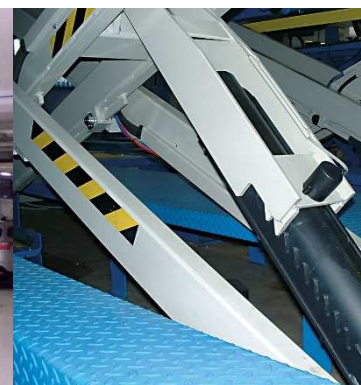
Zajištění polohy pomocí mechanických západek
