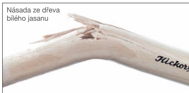
Násada ze dřeva bílého jasanu Hikorové dřevo drží díky svým dlouhým vláknům násadu pohromadě i v případě, že se násada zlomí.
